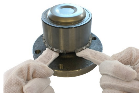
3. Remplacez-la dans la bonne position sur le roulement.
