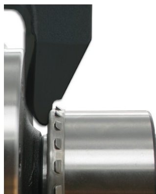
5. Utilisez l'outil de montage SKF VKN 600 pour monter le roulement.
