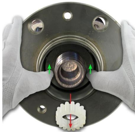
Le manchon en plastique sera automatiquement éjecté par la fusée d'essieu. Lors du montage du roulement, appliquer la pression sur la bague intérieure. Ne pas pousser le manchon en plastique manuellement avant le montage
