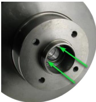
Lors de l'installation du roulement et du disque de frein, appliquer la pression SEULEMENT sur la bague intérieure du roulement.
