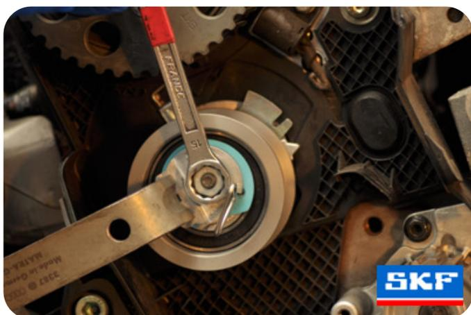
10) Poser le galet tendeur neuf (VKM 11250) avec la goupille montée. Tourner le cadran de réglage aussi loin que possible dans le sens horaire avec l'outil adéquat et serrer l'écrou à la main.
