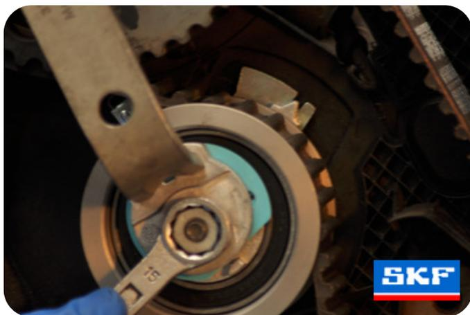
15) Serrer l'écrou de fixation du galet tendeur (20 Nm + 45°) et les vis de la poulie d'arbre à cames au couple de (25 Nm).
