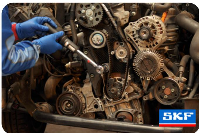
11) Poser la courroie neuve dans l'ordre suivant : poulie d'arbre à cames, galet tendeur, pignon de vilebrequin et pompe à eau.
